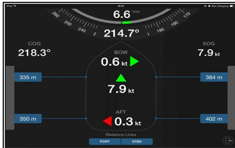
Modo Docking: Herramienta para maniobras de atraque y zarpe, donde se visualiza la velocidad de aproximación o salida de un muelle, la velocidad y dirección longitudinal, grados de giro y dirección del giro, rumbo del buque y distancias a muelles y otros buques, SOG y COG. (Fuente: TRANSAS - Wartsila Pilot Pro).
